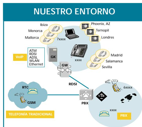
La primera fase del proyecto consistió en la instalación de un radioenlace WLAN (802.11b) entre el CTI y un edificio cercano situado a unos 4 km. Hasta ahora la comunicación telefónica entre la Universidad y dicho edificio era mediante telefonía tradicional a través de un operador telefónico. La instalación de telefonía IP permitiría utilizar el enlace de datos en vez del operador telefónico.
